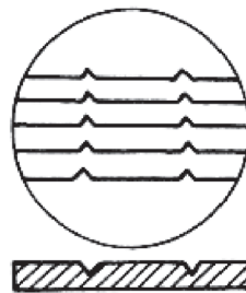
图2 划痕的干涉条纹图像
