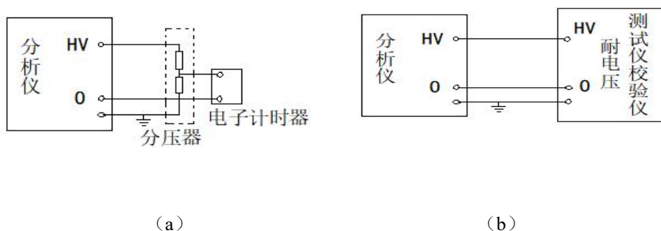
图 17 输出电压持续（保持）时间校准线路图
