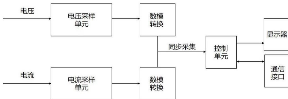
图1 变压器空载、负载损耗测试仪校准原理框图
